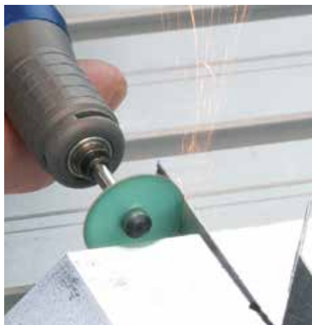
Alacsony hőmérsékletű vágás kerámiaszálas darabolókoronggal
