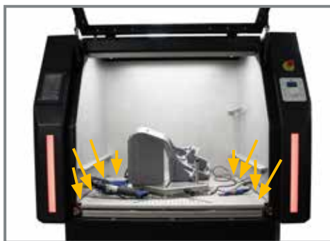
Megmunkálás után a rendszer nem nyitható ki, amíg a különleges automata tisztítási művelet véget nem ér. Ez felkavarja és elszívja a lerakódott porokat a munkakamra sarkaiból.
