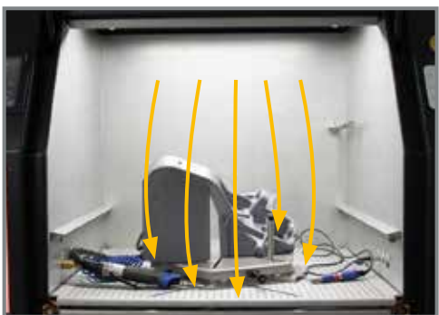
Áramlás-optimalizált légtereléssel a veszélyes porok az elszívó felé áramlanak.
