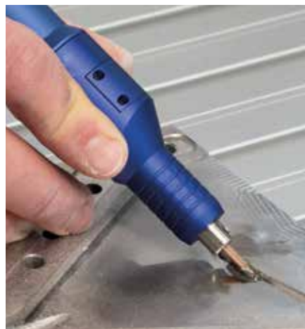
Fa csiszolórúd kézi reszelőgépbén
