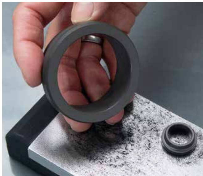
Mechanikus tömítők csiszolása
