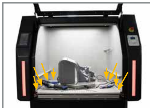
Megmunkálás után a rendszer nem nyitható ki, amíg a különleges automata tisztítási művelet véget nem ér. Ez felkavarja és elszívja a lerakódott porokat a munkakamra sarkaiból.
