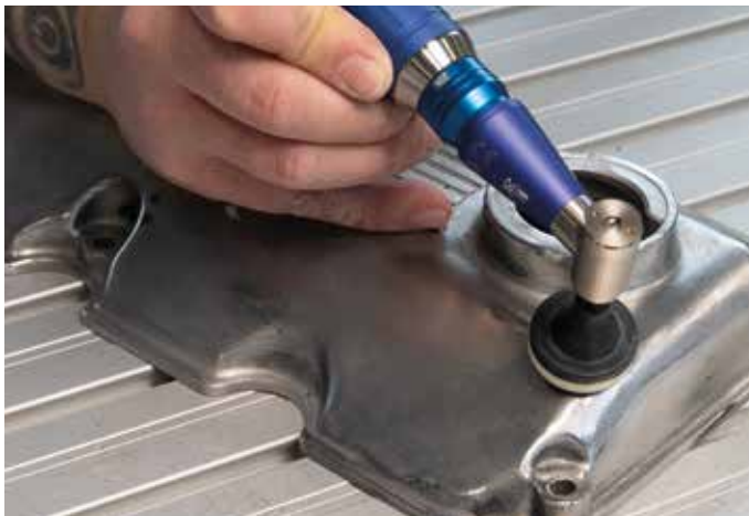
Alumínium polírozás szöghelyzetű kézigységgel, filccel
