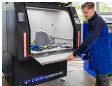
a kihúzható fiókba könnyen behullanak a munkadarabok támasztólábaip
